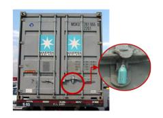
b. コンテナ右手側扉に位置 するセキュリティカム(左手 側)への装着 その際、コンテナシールの頭 を上に向けてください
