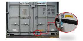
推奨するコンテナシール装着位置は蔵置中、ターミナルにおける取り扱い中、レールワゴンへ積載時クラムガードへの接触などによる衝撃、摩擦による損傷および破損を回避する為の予防策となります。また、コンテナシールの損傷および破損により貨物の安全及び安全保障の問題が発生し配達の遅延、追加費用発生が生じる可能性がございます。
